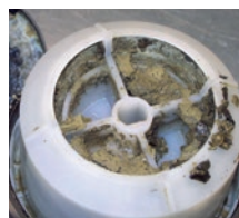
Bęben wirówki, osad powoduje obniżenie sprawności
