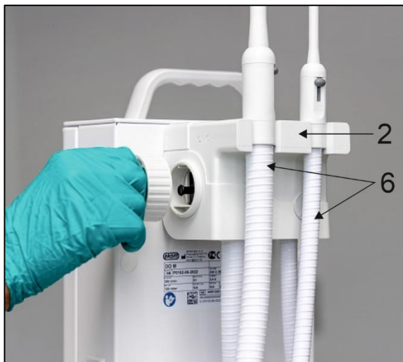
Rys. 10: Czyszczenie wlotowego filtra siatkowego
