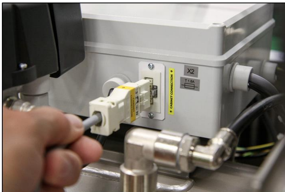
Obr. 13: Zapojenie skrinky ku kompresoru
