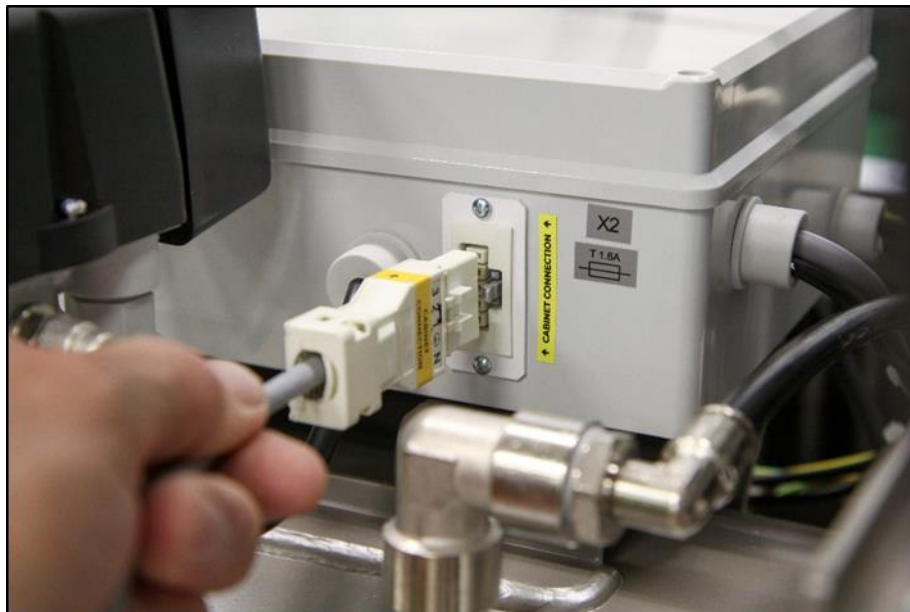
Abb. 13: Anschließen des Gehäuses an den Kompressor
