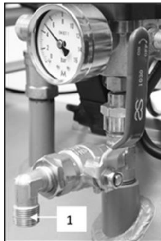
Abb. 8: Anschluss an den Druckluftausgang
