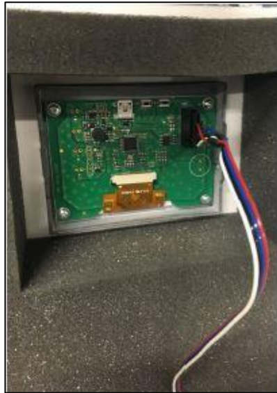
Abb. 17: Anschließen des Displaysteckers
