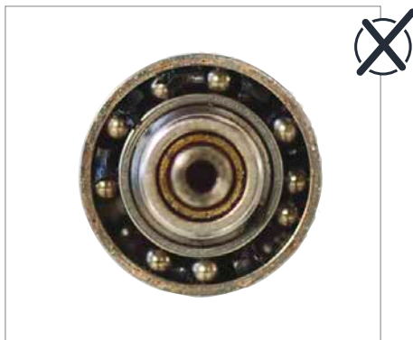
Uszkodzone łożysko kulkowe
